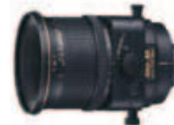
這款標準 PC 鏡頭擁有 f/2.8 的快速光圈，而且還具備微距能力，可以拍攝最高 1/2x 實物大小的近拍影像，支援俯仰、移軸和 +/-90° 旋轉機械裝置。非常適合商業拍攝、產品攝影、自然攝影或其他任何需要自然透視感和精緻細節的主體。電磁式光圈 \* 可實現自動光圈控制。鏡頭採用納米結晶塗層以降低鬼影和眩光效果。
