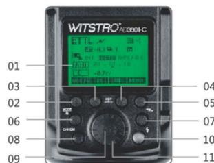
(1)点阵显示屏 (2)功能按钮1 (3) 功能按钮2 (4) 功能按钮3 (5) 功能按钮4 (6) MODE模式选择按钮 (7) 无线按钮 (8) ON/OFF电源开关 (9)SET设置按钮 (10) TEST试闪按钮/回电指示灯 (11) 调节旋钮
