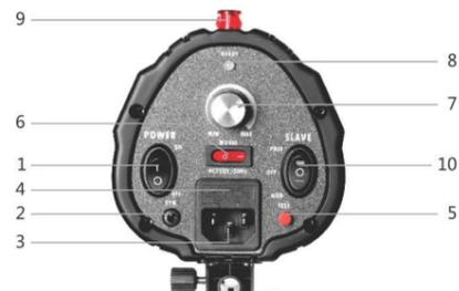
(1) 电源开关 (2) 同步线插孔 (3) 电源插座 (4) 保险丝 (5) 试闪按钮 (6) 造型灯开关 (7) 功率调节旋钮 (8) 充电指示灯 (9) 光控接收器 (10) 光控模式开关
