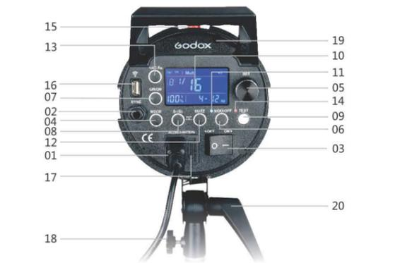
(1) 电源插座 (2) 同步线插孔 (3) 电源开关 (4) MODE选择按钮 (5) 闪光灯管功率调节按钮 (6) MOD/OFF造型灯按键 (7) GR/CH按键 (8) SLAVE光控模式按键 (9) TEST试闪按键 (10) 数码显示屏 (11) 造型灯指示灯 (12) 蜂鸣按键 (13) 无线/自定义按键 (14) 试闪指示灯 (15) 光控接收器 (16) 无线控制插座 (17) 保险丝座 (18) 固定旋钮 (19) 伞孔 (20) 方向调节把手
