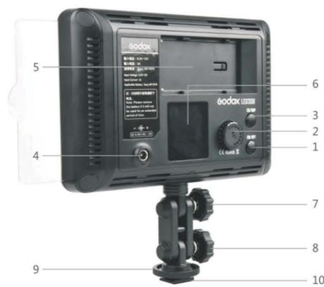
(1)ON/OFF按钮 (2)调节旋钮+SET按钮 (3)CH/GRP按钮 (4)DC电源插座 (5)锂电池插槽 (6)LCD屏(蓝底白字) (7)转轴固定旋钮A (8)转轴固定旋钮B (9)热靴固定旋钮 (10)热靴连接座
