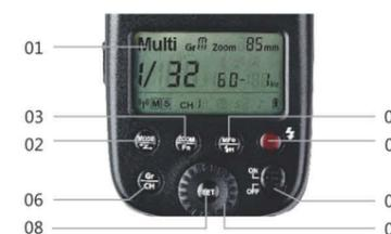
(1)高分辨率LED显示屏 (2) MODE闪光模式选择按钮/无线模式切换 (3) ZOOM/Fn 变焦/自定义按钮 (4) 辅助对焦开关/高速同步按钮 (5) 试闪按钮/回电指示灯 (6) GR/CH 组别/频道设置 (7) ON/OFF电源开关 (8) SET设置按钮 (9)调节旋钮
