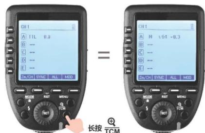
TCM转换功能，可将TTL模式的闪光值转换为M模式的功率值。
