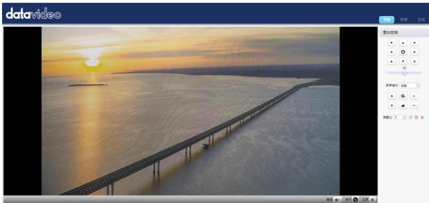
點選網頁使用者介面右上方的「配置」方塊開啟配置頁面。在左頁框內點選「網絡配置」，然後點擊「以太網參數」選項開啟網路設定頁面並將攝影機的連線模式更改為 DHCP 或固定 IP。
