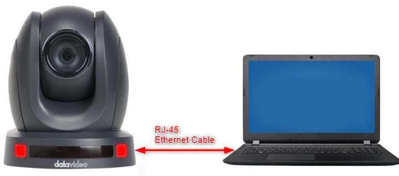
因 PTC-145 預設為 DHCP 模式，請在 DHCP 模式下登入到網頁使用者介面，點擊 Web UI 左方的「網路」選項來進入「網路」介面，然後點擊「DHCP」ON/OFF 開關來將其設為「DHCP OFF」，並手動在「IP 位址」、「子網路遮罩」、「閘道器」、「慣用 DNS 伺服器」及「其他 DNS 伺服器」等選項設定您想要的固定 IP 位址及資訊，並按下「應用」鍵，並將 PTC-145 重新開機，PTC-145 即會將您的 PTC-145 設為固定 IP 模式。此時即可將您的 PTC-145 與設於同一網域的電腦或筆電直接連接，並將固定 IP 位址輸入網路瀏覽器位址列來打開 PTC-145 Web UI。此處以固定 IP 位址「192.168.100.100」為例。
