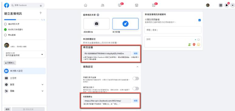
5. 此處以主串流為例，請將 PTC-145 Web UI 的「串流」>「主串流 ON/OFF」開關設為「ON」，並於「協議」下拉式選單選擇「RTMP(S)」，然後請將「伺服器網址」及「串流金鑰」分別複製，並以「串流網址/串流金鑰」的格式貼入到 PTC-145 Web UI 的「串流 > MRL」欄位中。最後再按下「套用」鍵。
