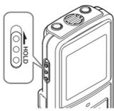
打开电源: 请按箭头指示的反方向移动 HOLD 开关。
