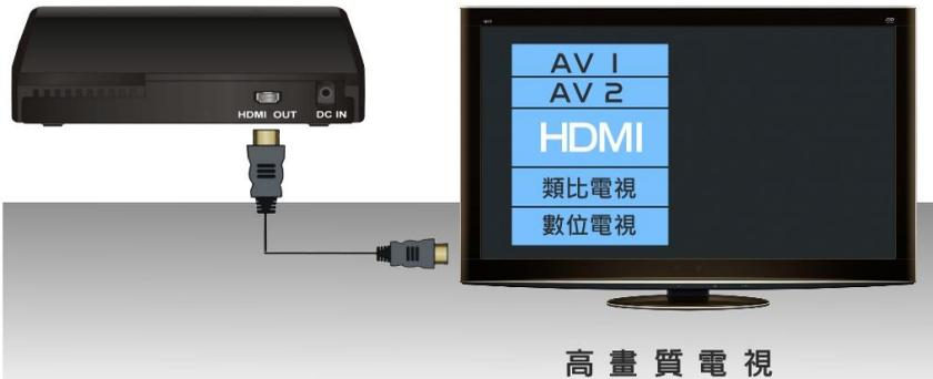
註：在未開啟電源下需先將 HDMI 線材操作連接完畢，HDMI 未支援熱插拔功能，若因此造成損壞，則視為人為疏失不在保固範圍內。
