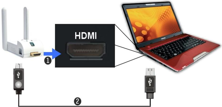
註：在未開啟電源下需先將 HDMI 線材操作連接完畢，HDMI 未支援熱插拔功能，若因此造成損壞，則視為人為疏失不在保固範圍內。
