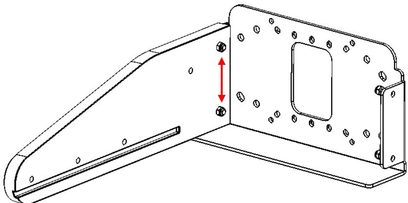
3. 如下圖所示，利用兩支 **M5x20 鎍鎳內六角螺絲** 將右支架鎖至固定架。
