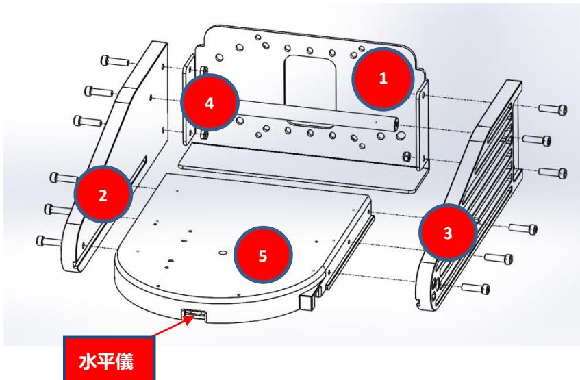
1. 如下圖所示，將固定架與先前的四個鑽孔對齊，並利用四支膨脹螺絲將其鎖緊。
