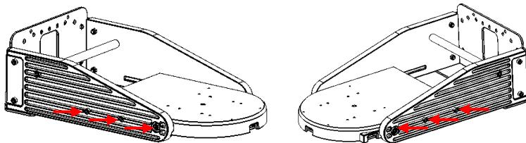
注意：您可透過水平儀確保固定架安裝正確，意即與水平線平行。若氣泡位於中心，即代表固定架與水平線平行。若氣泡位於兩端的其中一端，即代表固定架往氣泡端傾斜。
