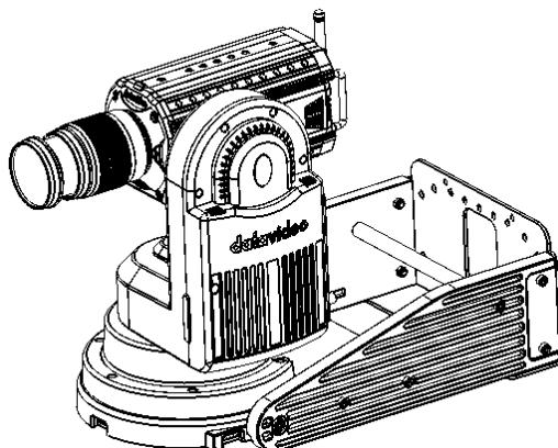
若 PTR-10/10T 安裝至 WM-10 之後發現有晃動的情形，您可使用四支 M3 x 8mm 螺絲由底部往上鎖進到如下圖所示的四個螺絲孔，以加強穩固效果。
