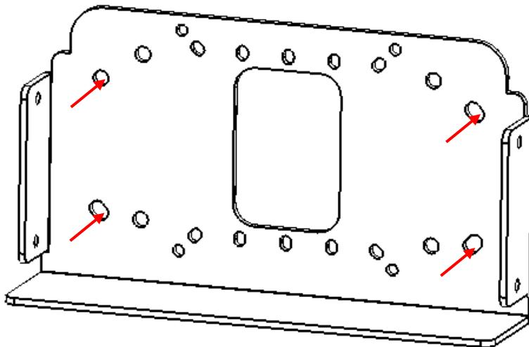
2. 如下圖所示，利用兩支 **M5x20 鎔鎳內六角螺絲** 將左支架鎖至固定架。
