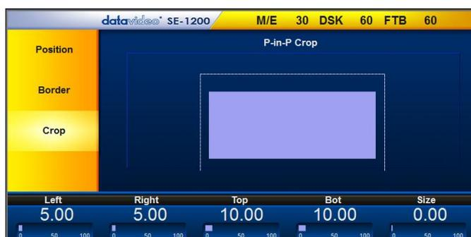
裁切大小的邊界值有**左(Left)**、**右(Right)**、**上(Top)**及**下(Bottom)**。四個參數可個別單獨調整或使用Size參數同步調整。如需調整子母畫面視窗的單一個邊界值，您只需點選所需調整的邊界值。
