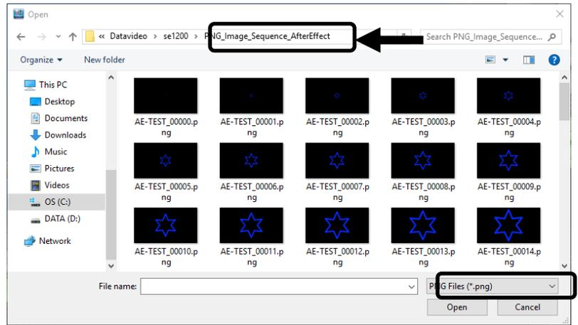
點擊「open」鍵可啟動動畫檔案載入。若您的檔案不是 SE-1200 MU 的 PIC 檔案格式，SE-1200 MU 的控制介面軟體即會先自動轉換成 PIC 檔案格式。
