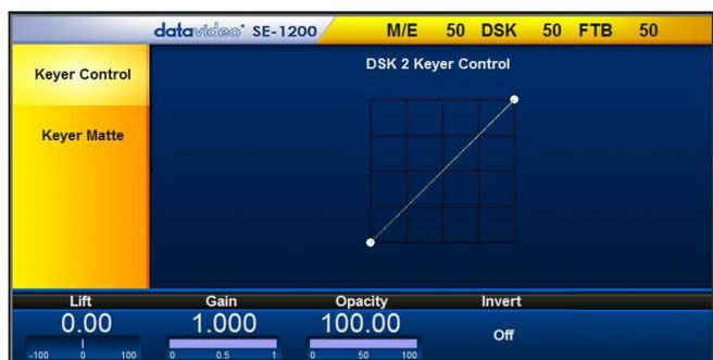
在螢幕下方藍色列內的選項可讓您透過調整 **Lift**、**Gain**、**Opacity** 及 **Invert** 功能校正白色或黑色關鍵訊號。請參閱 [Keyer Control 章節 \(7.1.1\)](#)所敘述的 **Lift**、**Gain**、**Opacity** 及 **Invert** 功能效果。
