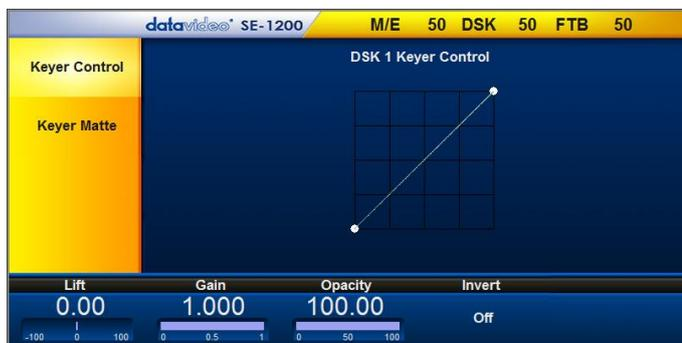
在螢幕下方藍色列內的選項可讓您透過調整 **Lift**、**Gain**、**Opacity** 及 **Invert** 功能校正白色或黑色關鍵訊號。[Keyer Control 章節 \(7.1.1\)](#) 會敘述 **Lift**、**Gain**、**Opacity** 及 **Invert** 功能的效果。
