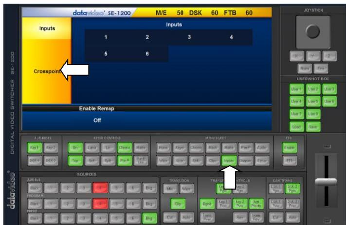
指定訊號功能可將 SE-1200 MU 實體輸入來源互換，可在 **Inputs** 選單的 **Crosspoint** 選項設定。
