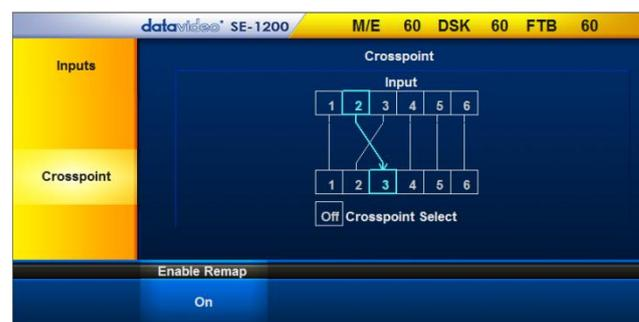
點選要互換的輸入(下排)，之後再點選輸入來源(上排)完成連結。以上的案例為輸入 2 和輸入 3 互換。
