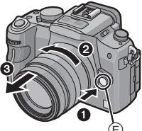
2 Enforcez la touche de déverrouillage de l'adaptateur **F**, puis retirez la lentille en la tournant dans le sens de la flèche jusqu'à ce qu'elle se bloque en position.
