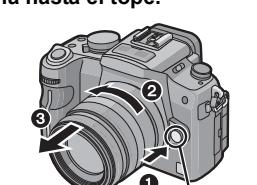
2 Mantenga abajo la palanca de desbloqueo **F** del adaptador montura, y quite la lente girándola en la dirección de la flecha hasta que tope.
