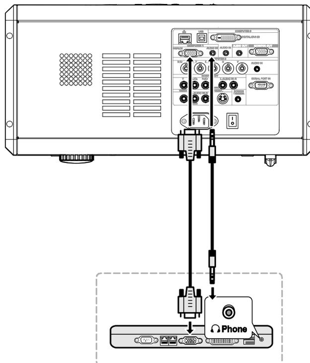
2. 開啟投影機的電源，然後從來源功能表選擇已選擇的連線方式，再開啟 PC 的電源（請參閱第 27 頁的「選擇輸入來源」）。
