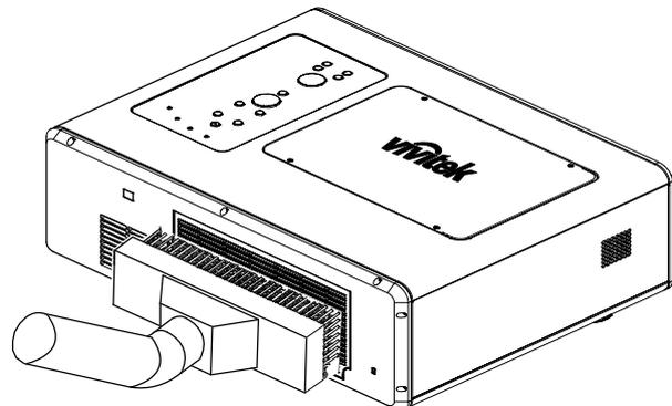
一旦清理濾網完畢，請使用第 80 頁的「重設功能表說明和功能」中提及的「清除濾網使用時間」選項使用時。
